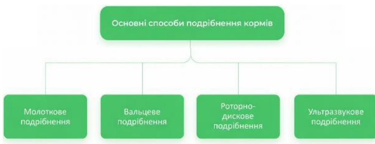
Рисунок 1.5 – Ключові способи подрібнення кормової сировини
