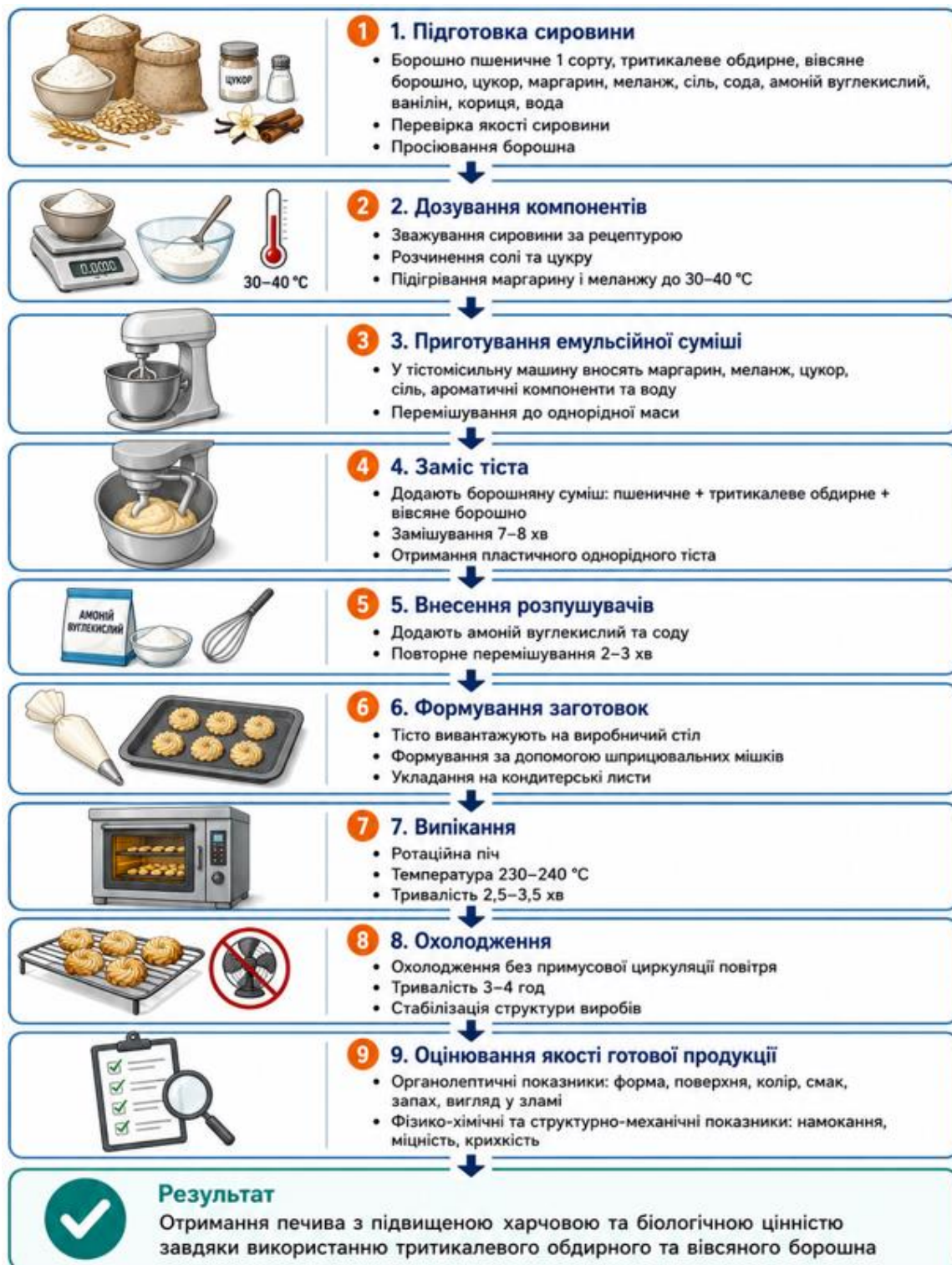
Рисунок 3.10 – Схема технологічного процесу виробництва печива «Корисне»
