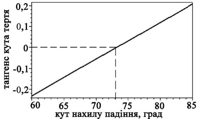
Рисунок 2.3 - Залежність тангенса кута тертя від кута нахилу дотичної до траєкторії падіння часток
