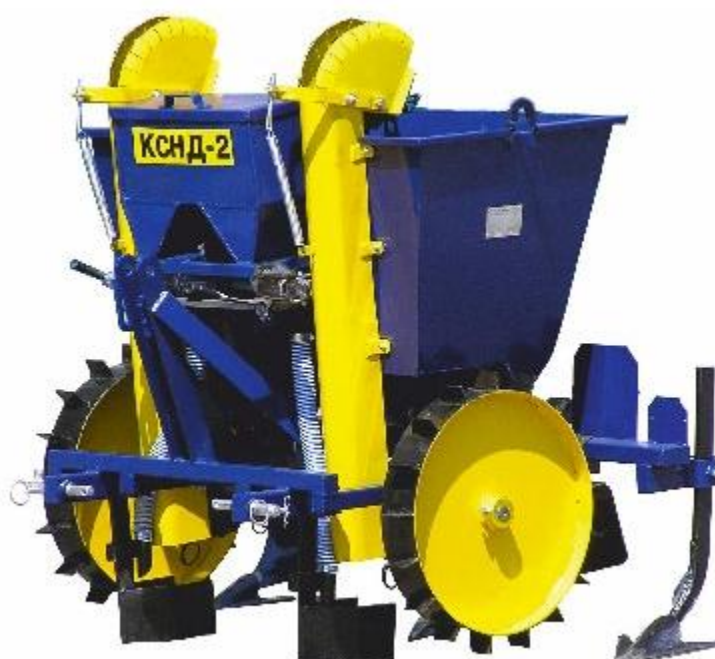
Рисунок 3.3 - Саджалка картопляна навісна (з туками) КСНД-2
