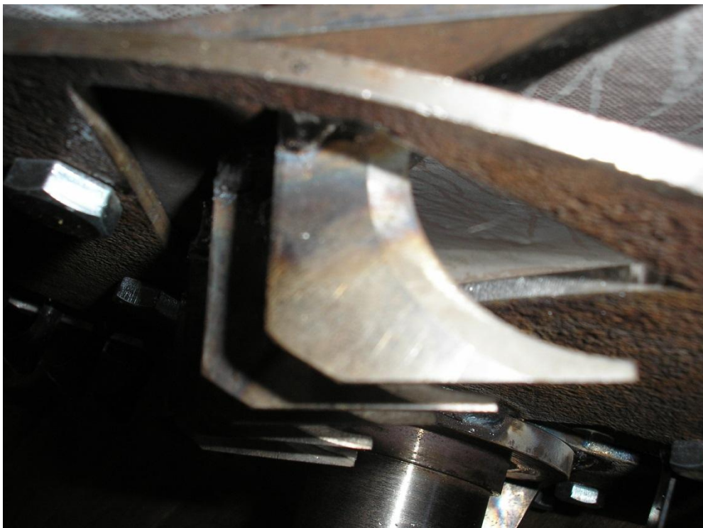
Рисунок 3.4 – Розташування ножів-подільників на робочому органі
