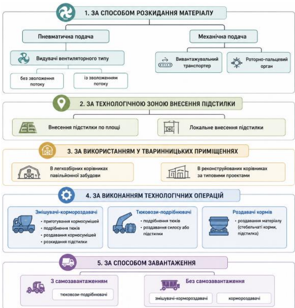
Рисунок 3.1 – Систематизація сучасних технічних засобів для розподілу солом'яної підстилки
