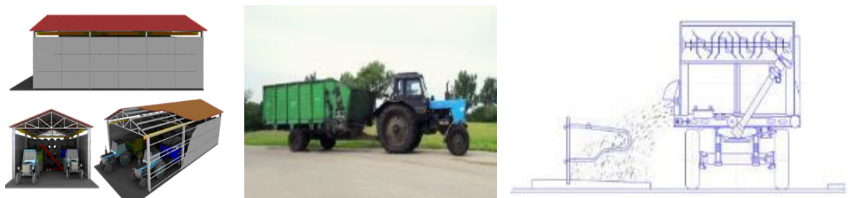
Рисунок 2.6 – Розроблена схема зберігання, транспортування та роздавання соломи в корівнику
