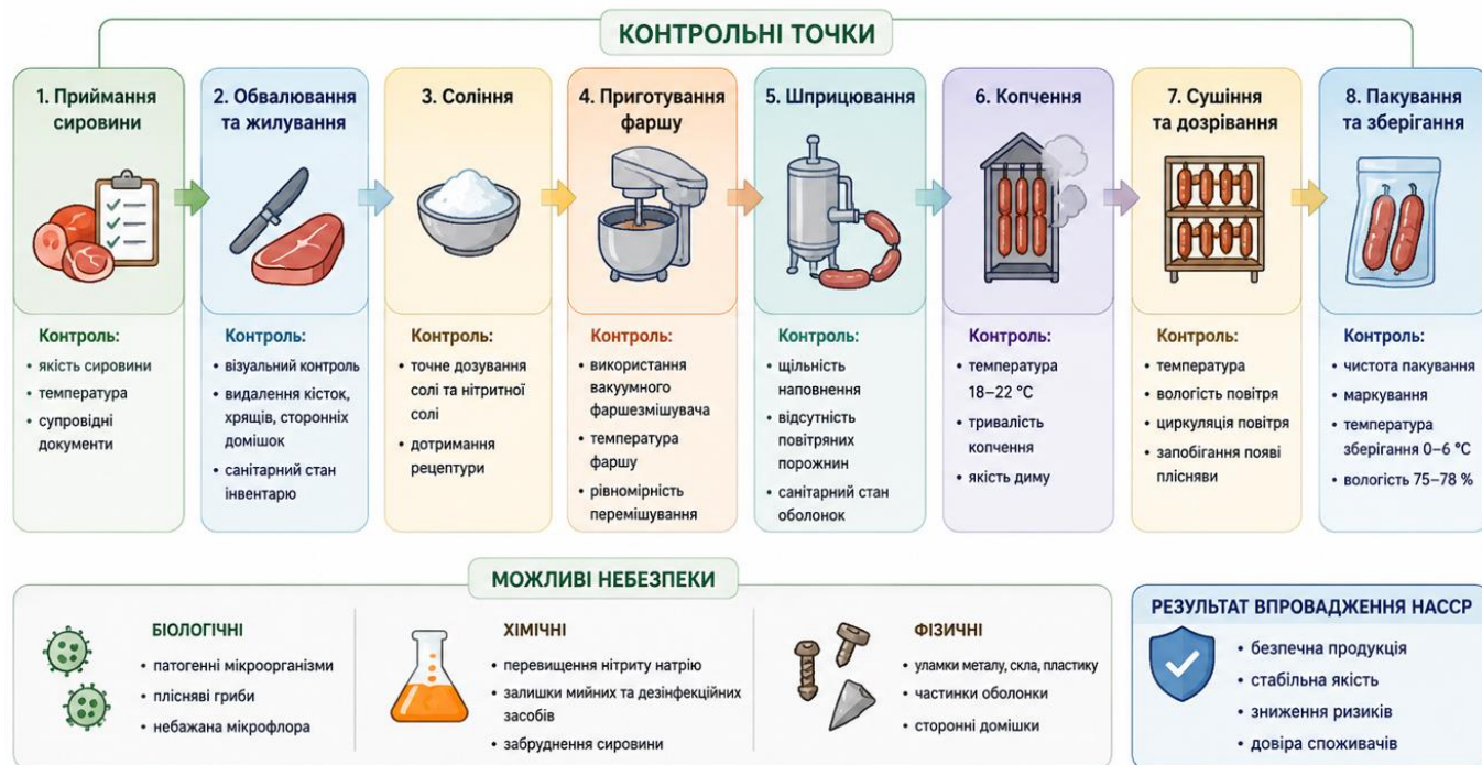
Рисунок 4.1 – Елементи НАССР під час виробництва сиркопчених ковбас
