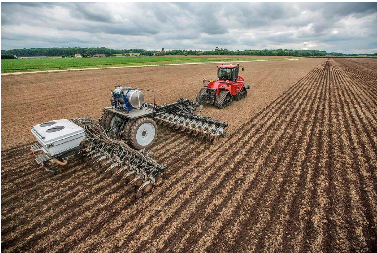
Рис. Смуговий обробіток ґрунту за технологією strip-till із локальним внесенням добрив і точним GPS-позиціонуванням агрегату
