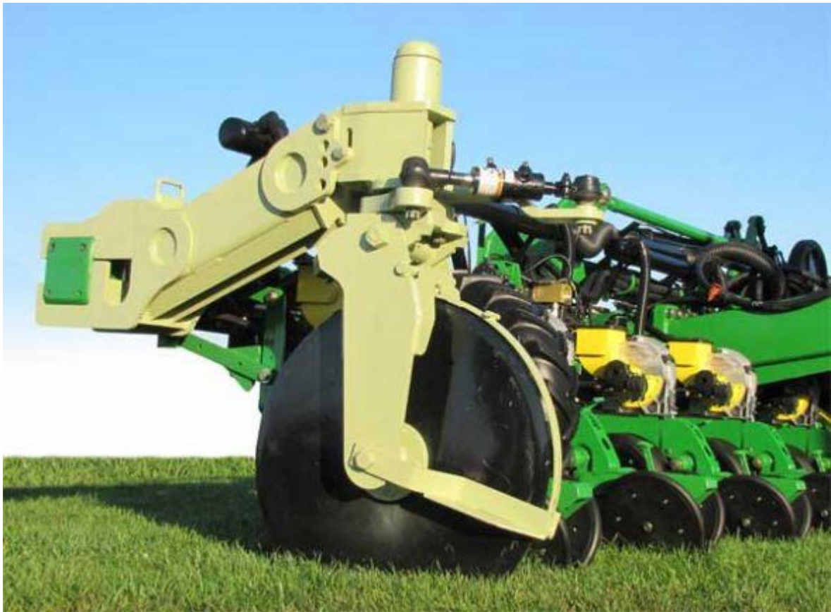
Рис. GPS-керований агрегат смугового обробітку ґрунту з VRA-диференційованим внесенням рідких добрив
