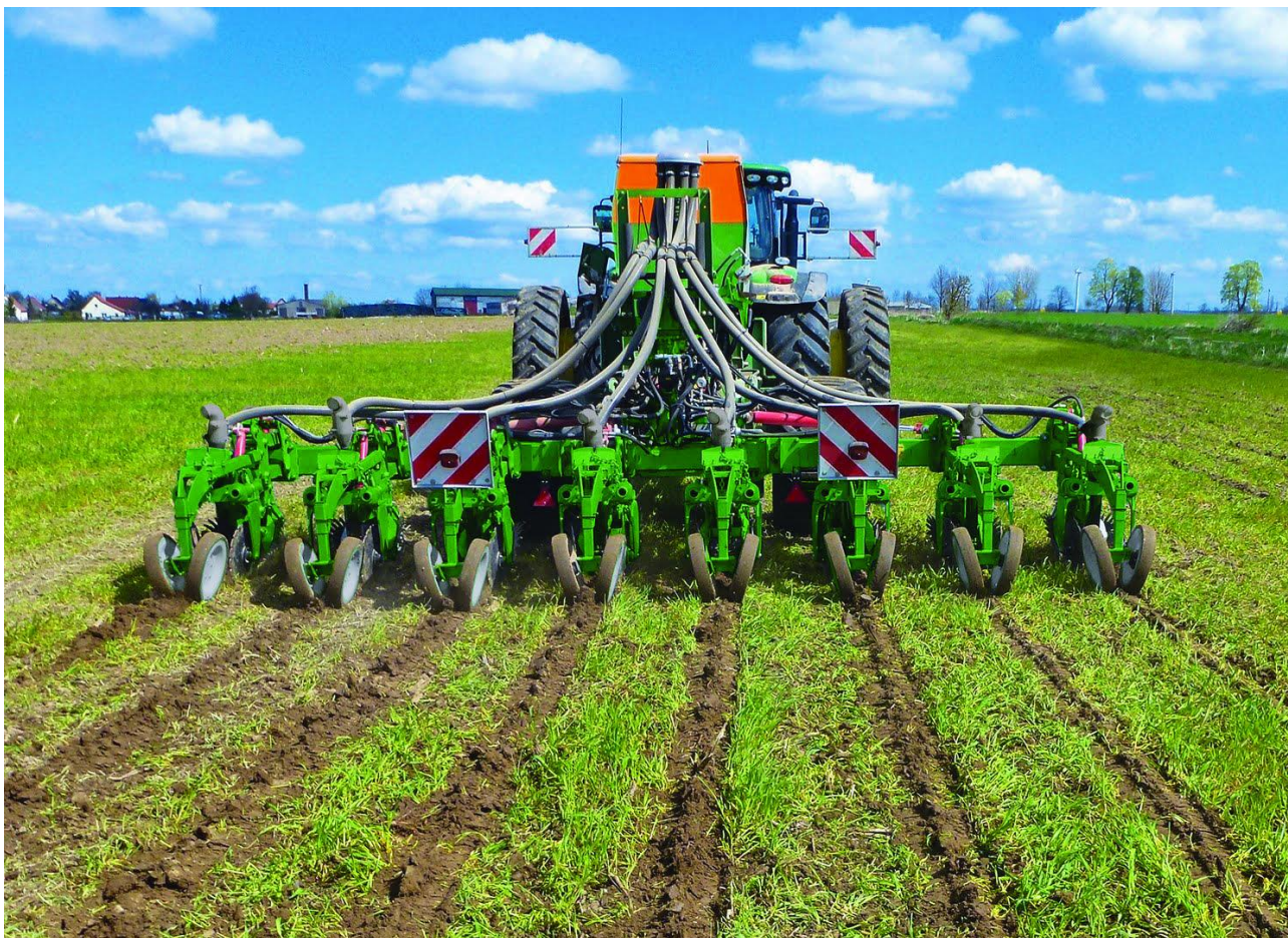
Рис. Трактор з культиватором для міжрядного обробітку ґрунту з GPS-контролем і VRA-диференційованим внесенням рідких добрив
