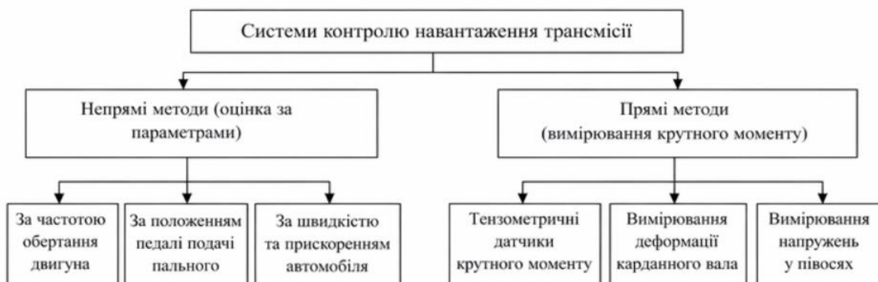
Рисунок 2.5. Класифікація основних способів контролю навантаження силової передачі
