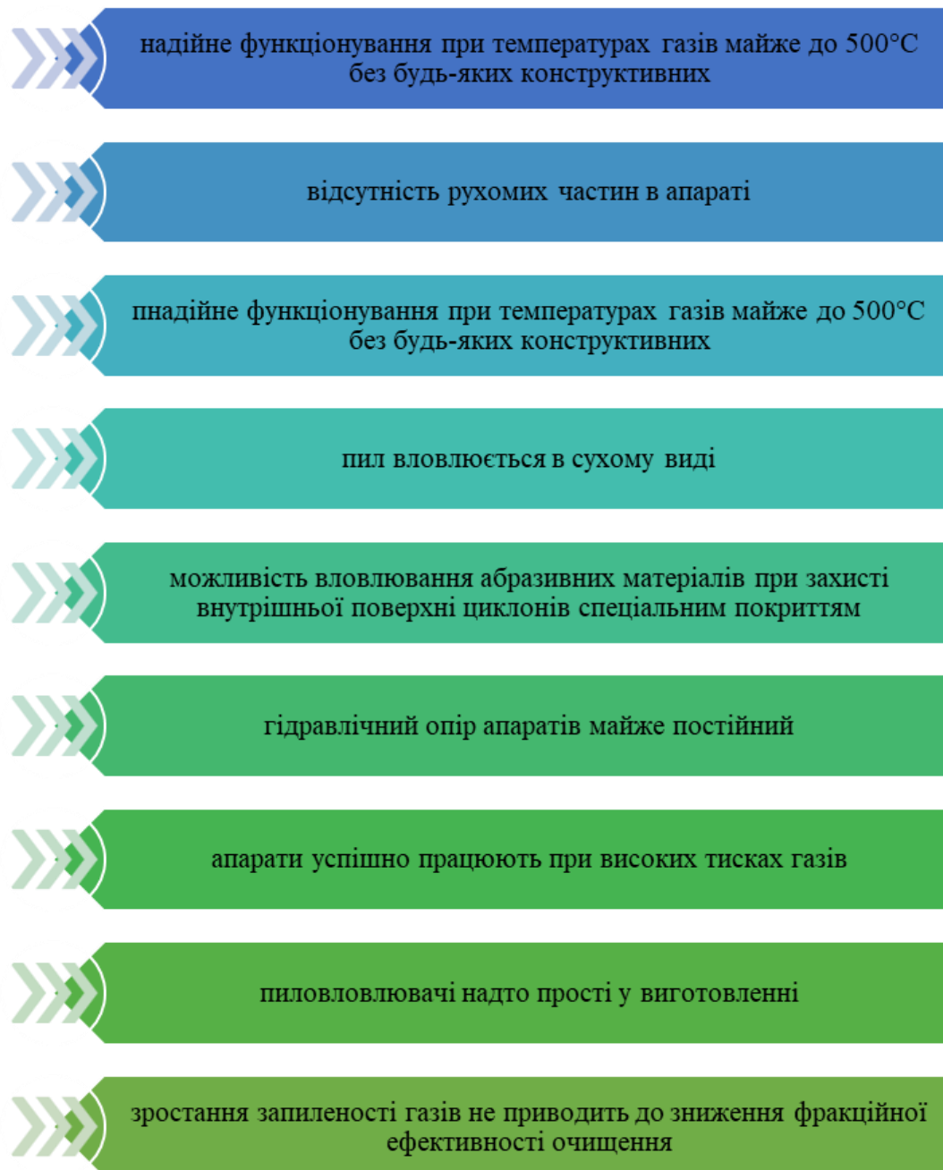
Рисунок 2.7 – Переваги циклонних апаратів у порівнянні з іншим технологічним обладнанням для очистки від пилу
