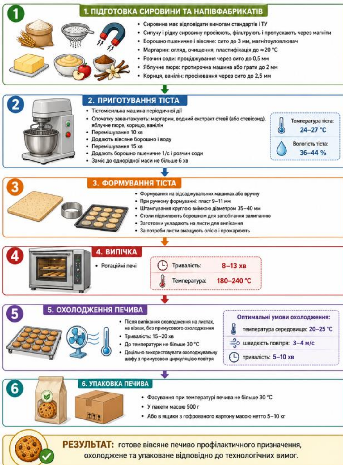
Рисунок 3.7 – Технологічна схема виробництва вівсяного печива зі стевіозидом
