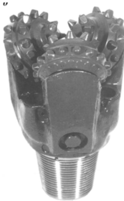
Рисунок 4.2 - Схема тришарошкового долота
