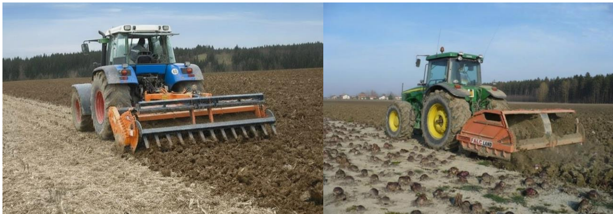
Рисунок 1.1 – Роторний плуг Free Land 3000 та Falc Falcland
