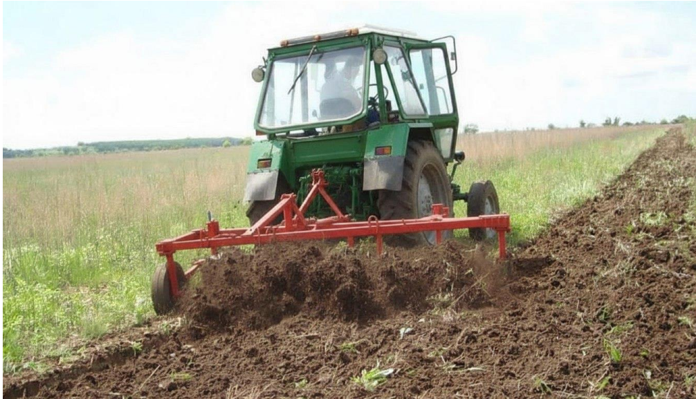
Рисунок 1.10 – Модернізований плуг під час обробітку сидеральних культур
