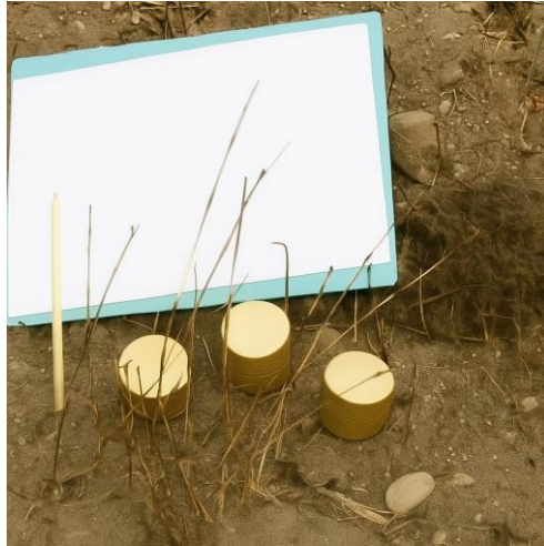
Рисунок 3.2 – Прилади для визначення об'ємної маси та вологості ґрунту
