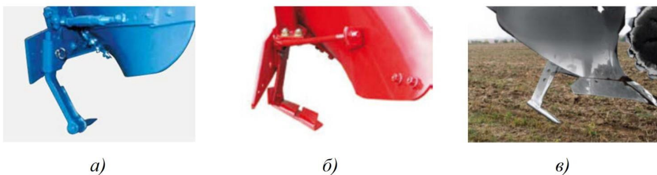
Рис. 1.4. Комбіновані робочі органи плугів для відвальної оранки з одночасним розпушуванням підорного шару: а – Lemken Juwel (Німеччина), б – Kverneland Eco (Норвегія), в – Amazone Cayros (Німеччина).
