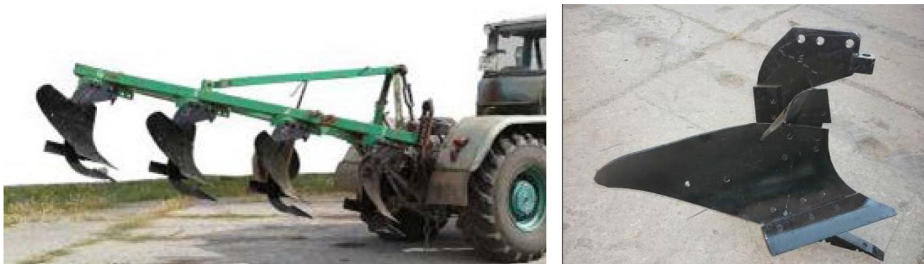
Рис. 1.3. Плуг ПЛН-4-35 з комбінованими відвальними робочими органами з ґрунтопоглиблювачами
