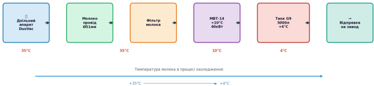
Рисунок 2.4 – Схема первинної обробки та охолодження молока на фермі
