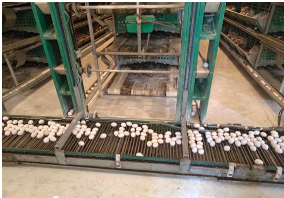
Рис. 4. Конвеєрна система транспортування яєць
