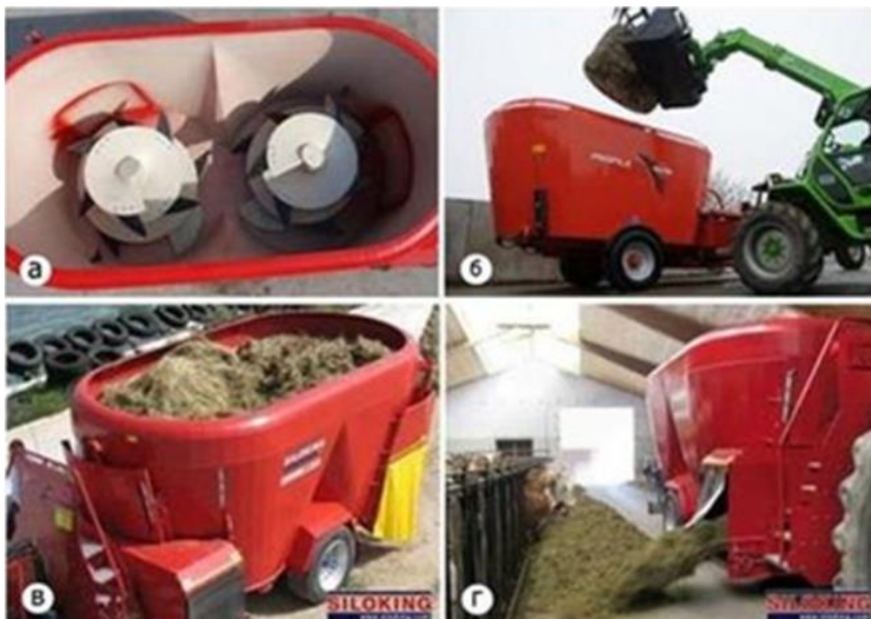
Рисунок 3.8 - Робочий процес кормороздавача-міксеру Siloking: а – вигляд зверху; б – завантаження тюкованої маси; в – процес змішування і подрібнення кормів; г – процес роздавання кормів
