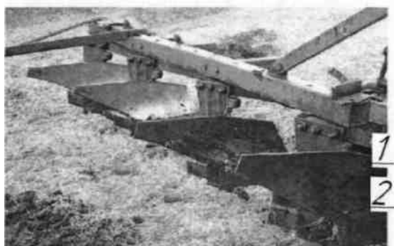
Рисунок 3.21. - Плуг ПЛН-4-35 з експериментальними робочими органами:
