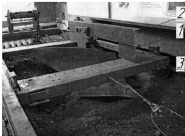
Рисунок 3.15. - Визначення працездатності запропонованого робочого органу в ґрунтовому каналі.
