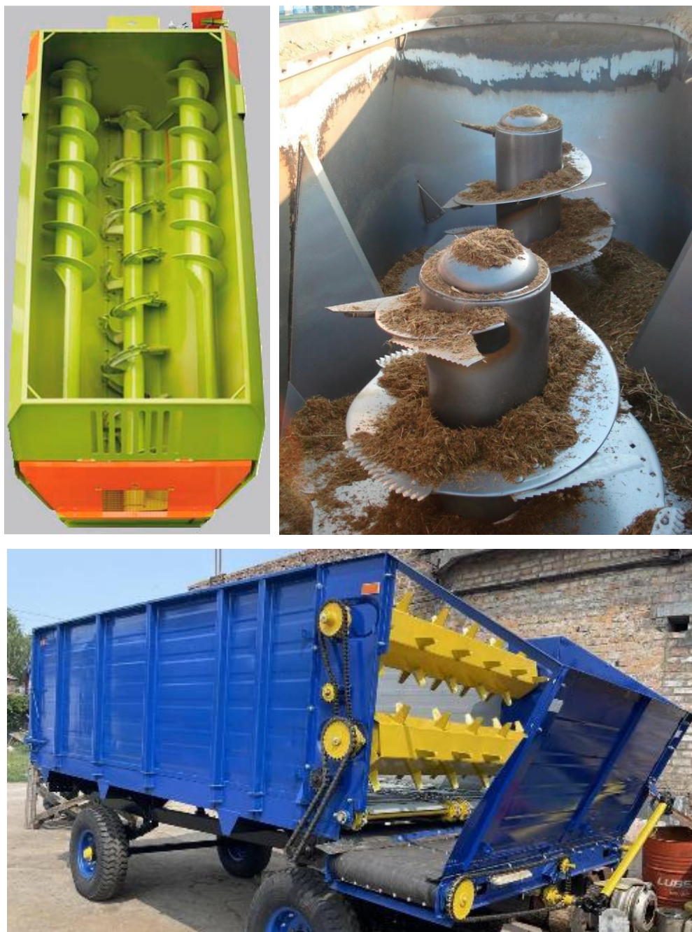
Рисунок 3.2 – Робочі органи кормороздавачів-змішувачів
