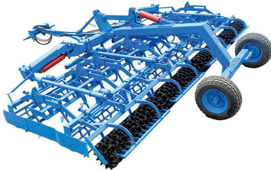
Рис. 2.22. Агрегат комбінований К 400 Gamma (Lemken GmbH & Co. KG)
