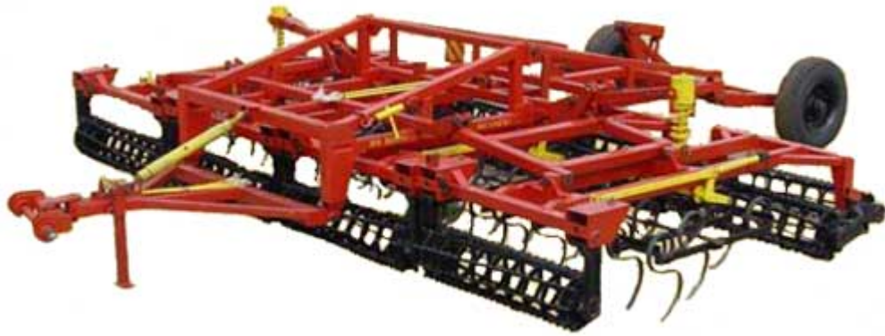
Рис. 2.16 Грунтообробний комбінований агрегат РВК-3,6
