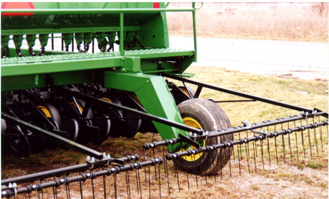
Рис. 2.13. Двослідна пружна борона для суцільного обробітку ґрунту.
