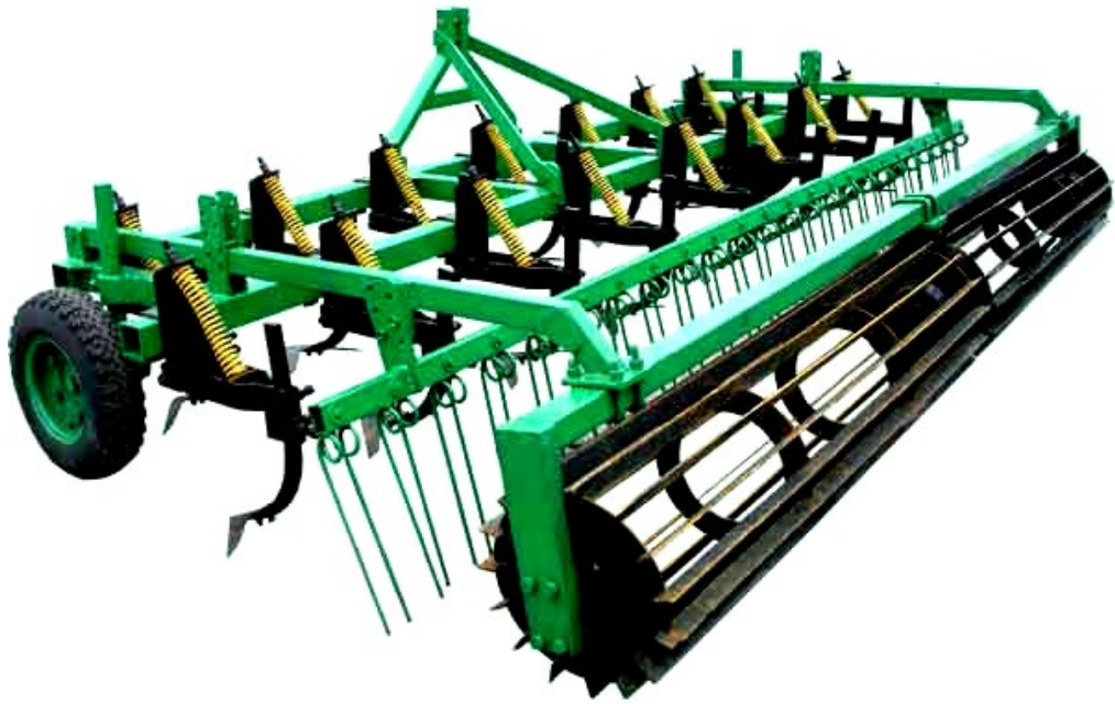
Рис. 2.14. Однослідна пружна борона для суцільного обробітку ґрунту.
