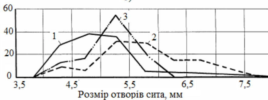
Рисунок 2.3 – Полігони розподілу за розмірами при просіюванні на ситах з круглими (а), прямокутними (б) і трикутними (в) отворами:
