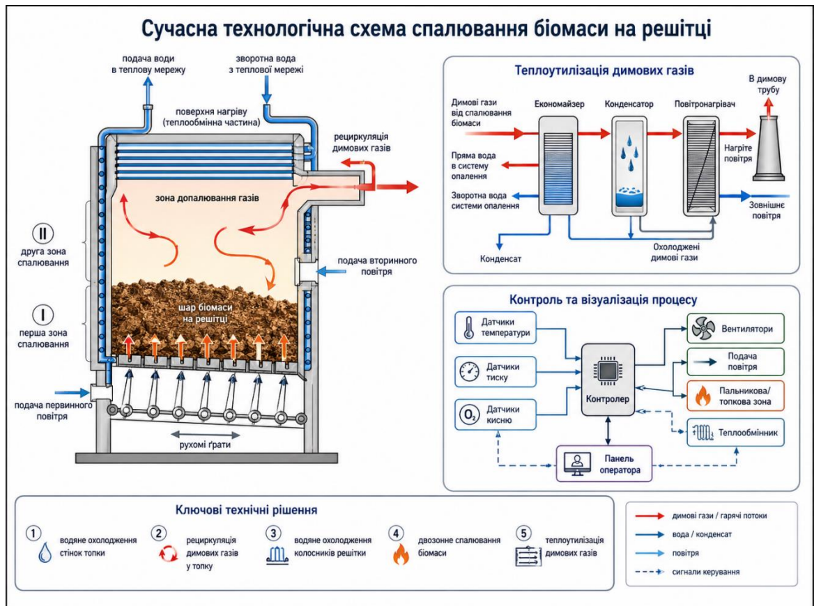
Рисунок 2.6 – Сучасна технологічна схема спалювання біомаси на решітці
