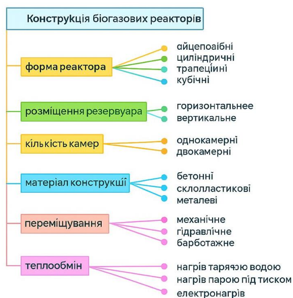
Рисунок 1.1 – Конструктивні особливості біогазових установок
