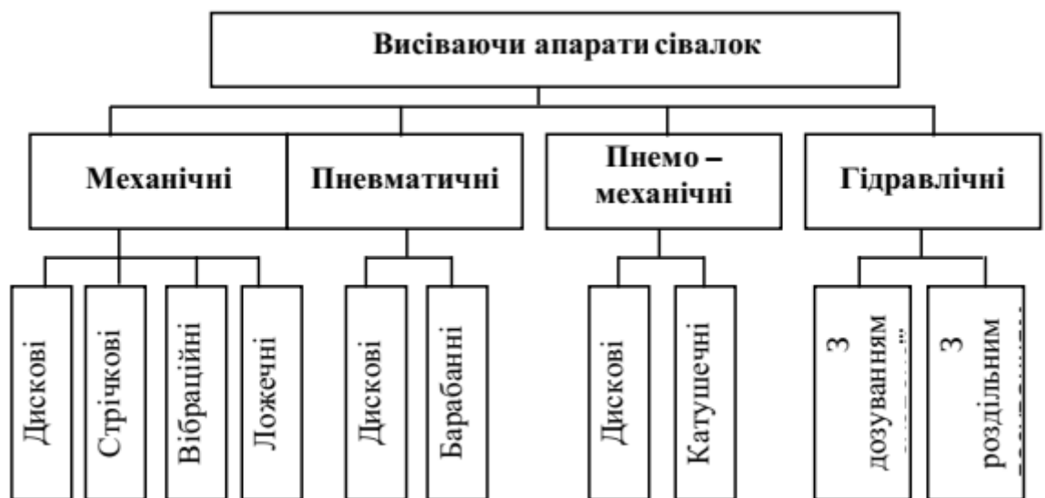
Рис. 2.2. Класифікація посівної техніки за типом висівного апарату
