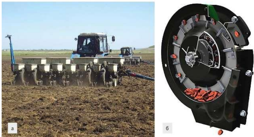
Рис. 2.11. Сівалка точного висіву KINZE-3000 (а) з механічним висівним апаратом ложкового типу (б)
