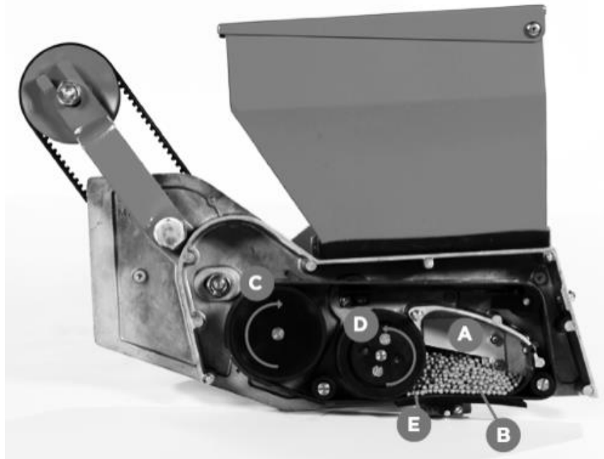
Рис. 2.10. Секція сівалки «Stanhay» з пасовим висівним апаратом
