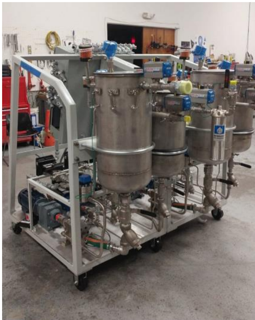
Рисунок 1.1 - Загальний вигляд модульного обладнання для рідкої годівлі C-Los від SKOV
