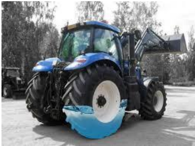
Рисунок 2.5 – Баластування тракторів рідиною
