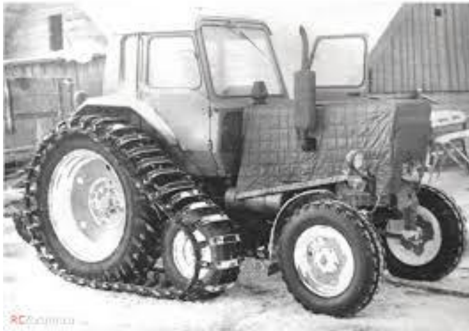
Рисунок 2.6 – Напівгусеничний рушій універсально-просапного трактора тягового класу 1,4 т
