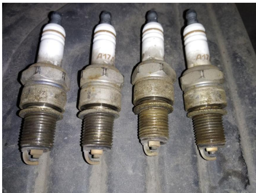
Рисунок 3.1 – Свічки запалювання двигуна MeM3-307 до проведення робіт
