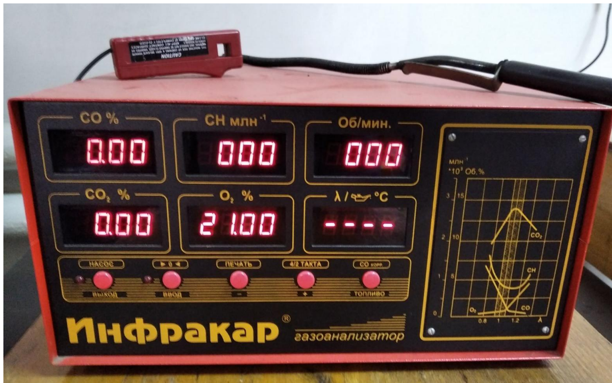
Рисунок 2.1 – Газоанализатор «Инфракар-М» з датчиком частоти обертання колінчастого валу та зондом для діагностування
