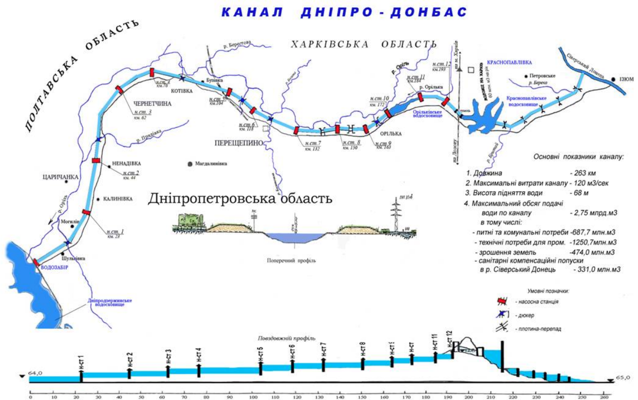
Рисунок 1.3 – Схема та загальна характеристика каналу Дніпро-Донбас
