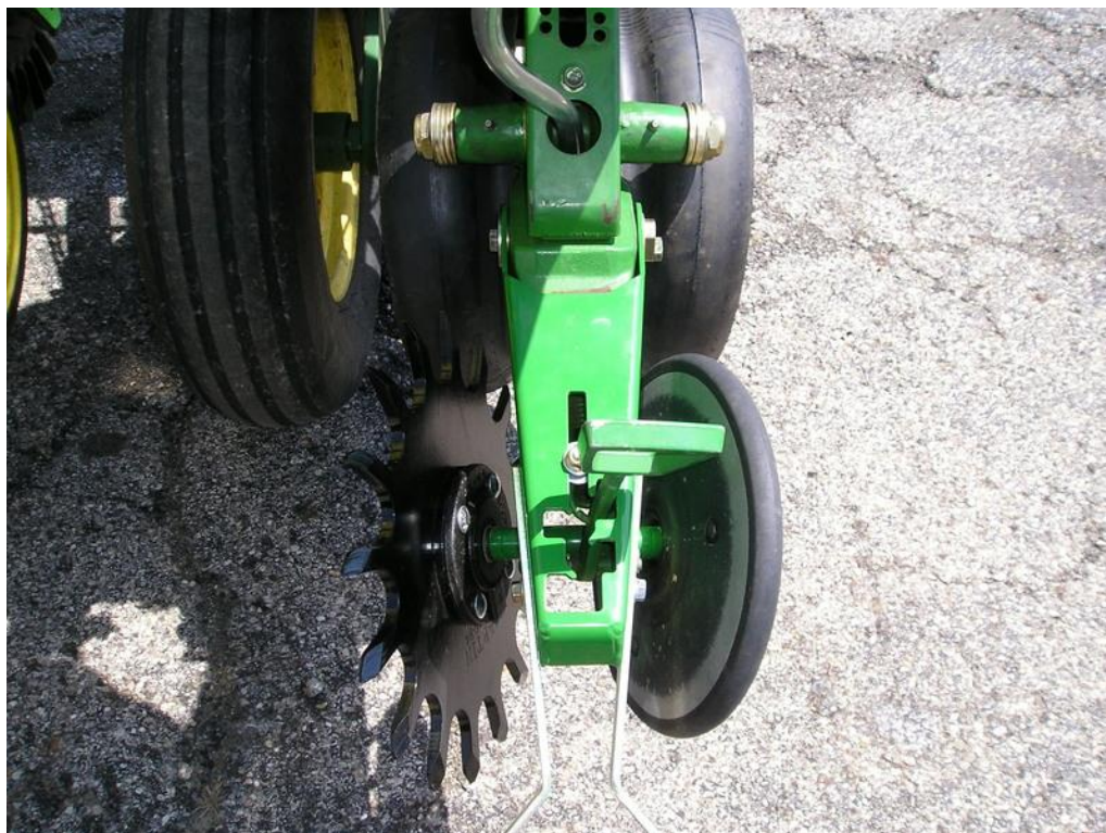
Рисунок 3.2 – Комбінований варіант: гумове та шиповане прикочуюче колесо на секції сівалки John Deere
