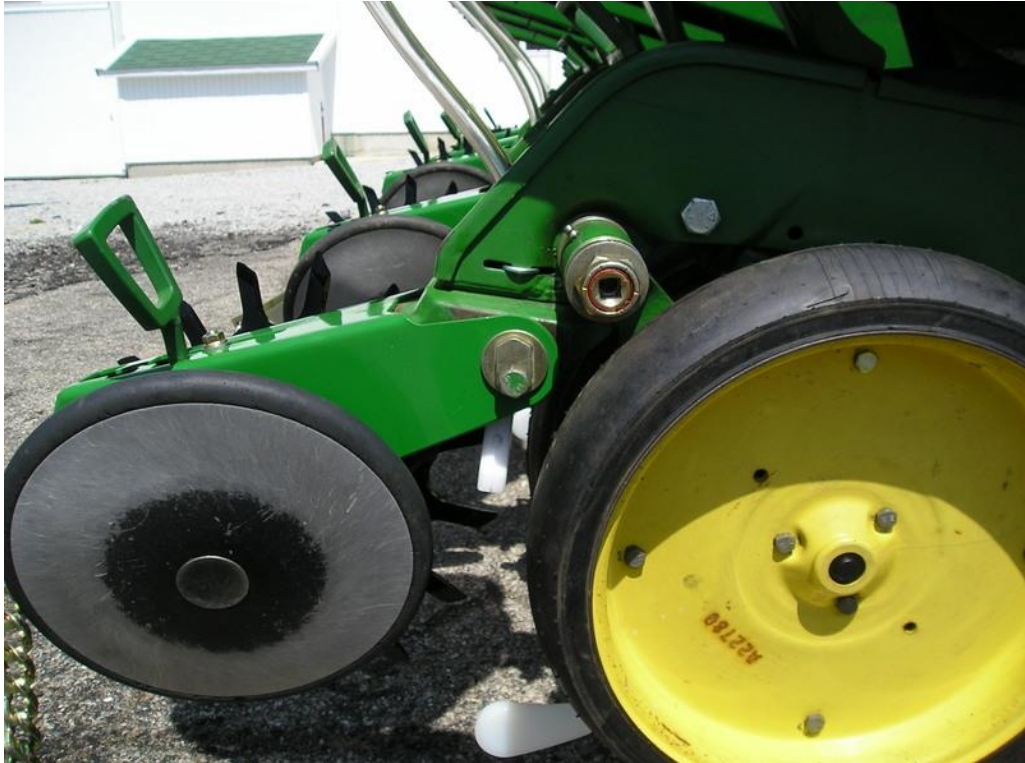
Рисунок 3.1 – Приклад гладкого гумового прикочуючого колеса на секції сівалки John Deere
