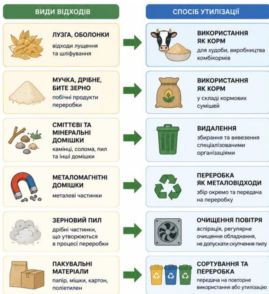
Рисунок 5.2 – Схема утилізації відходів круп'яного виробництва
