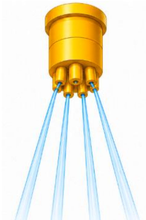
Рисунок 2.13 – Принцип роботи багатоструменевого розпилювача
