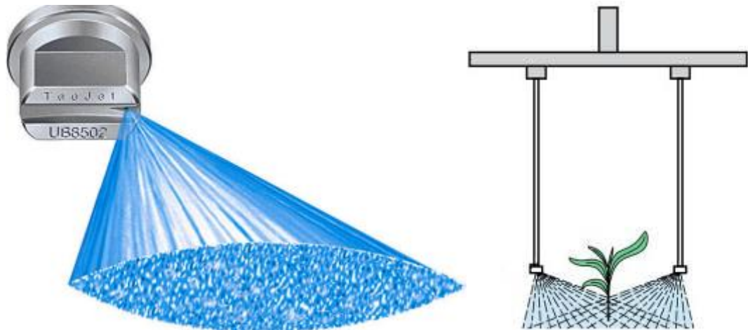
Рисунок 3.3 – Загальний вид та схема роботи обраного розпилювача
