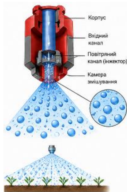
Рисунок 2.14 – Принцип роботи інжекторного розпилювача
