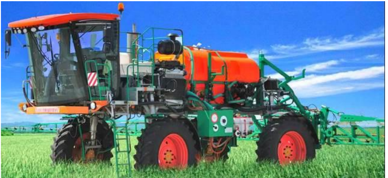
Рисунок 2.10 – Самохідний обприскувач Львівагромашпроект ОСШ-3,5-27 (Україна)
