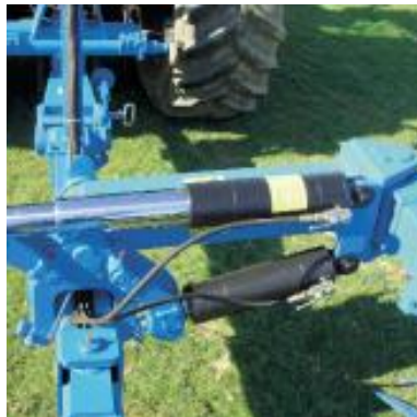
Рис. 3.15. - Загальний вигляд поворотного механізму плуга фірми Lemken Opal 110
