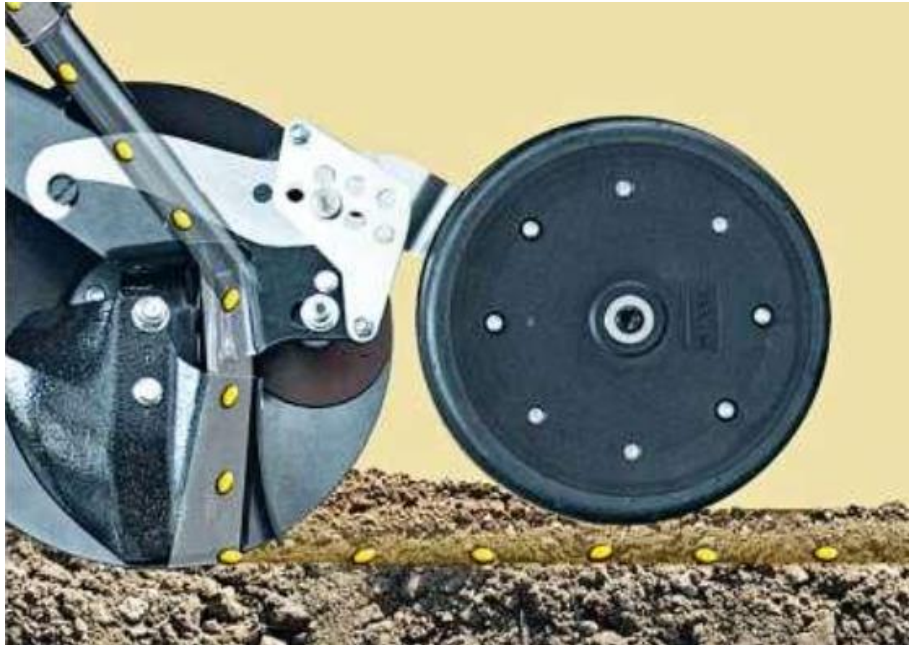
Рис.1.3. Однодискові сошники з вертикально встановленим диском
