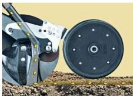
Одностисковий сошник з вертикально встановленим диском
