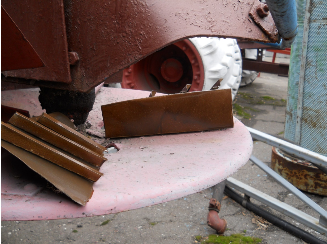
Рис. 3.13. Підготовка до роботи розкидача мінеральних добрив МВУ-0,5 із запропонованим диском
