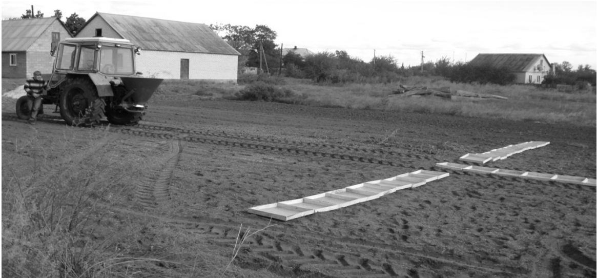
Рис.4.15. Польові дослідження машини Garmet-500 при русі, відхиленому від поступального, з розробленим робочим органом
