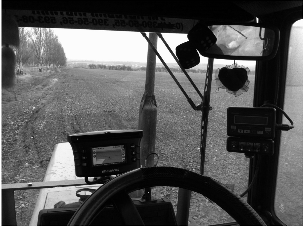
Рис. 3.10. Забезпечення стикового перекриття за допомогою навігатора
