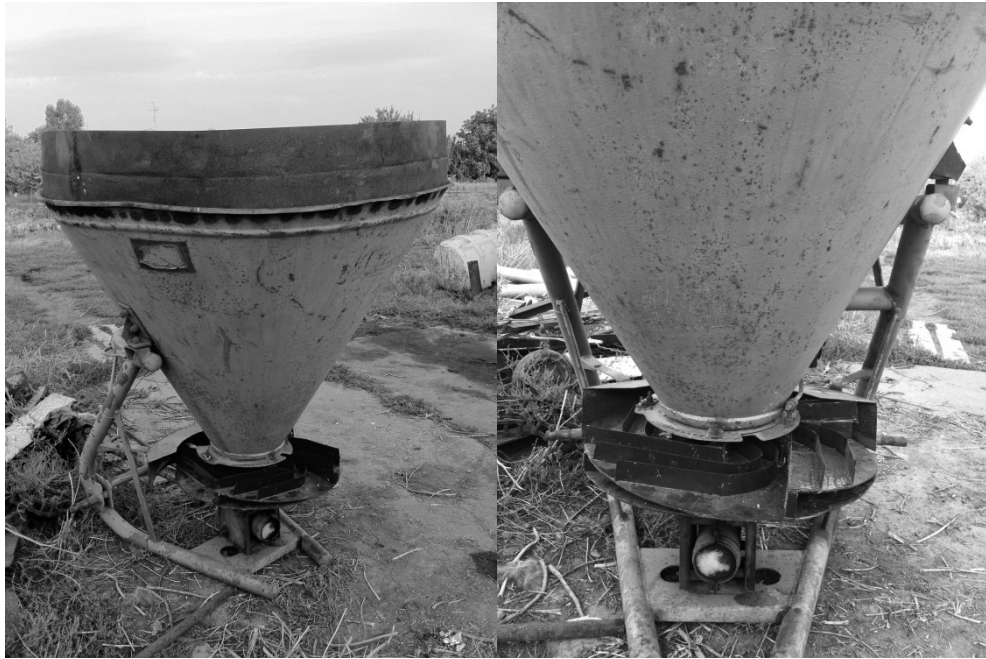
Рис. 4.12. Навішування розробленого відцентрового робочого органа на машину МВУ-0,5
