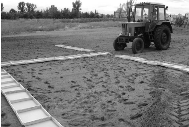
Рис. 3.12. Розміщення лотків по полю для визначення рівномірності внесення добрив
