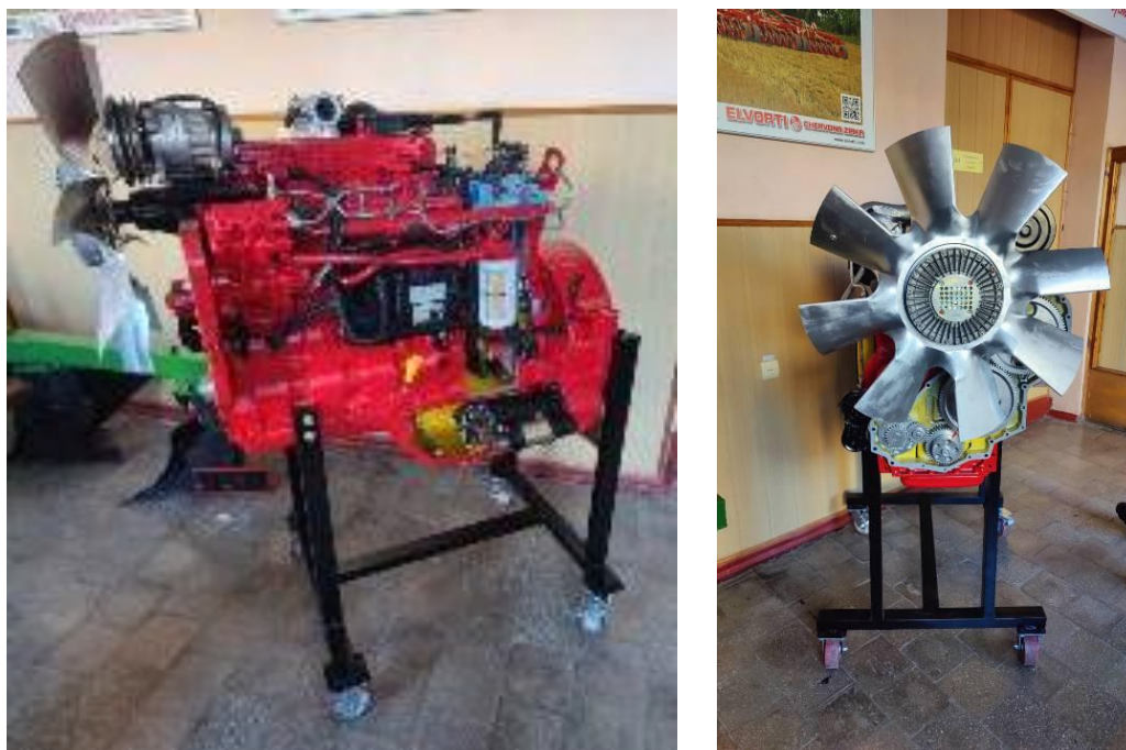
Рисунок 3.2 Навчальний макет дизеля Cummins 6TAA 9.0-04L
