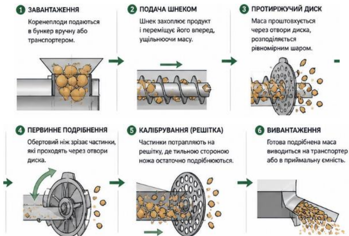
Рисунок 3.4 – Конструкції робочого органу розробленого подрібнювача коренеплодів
