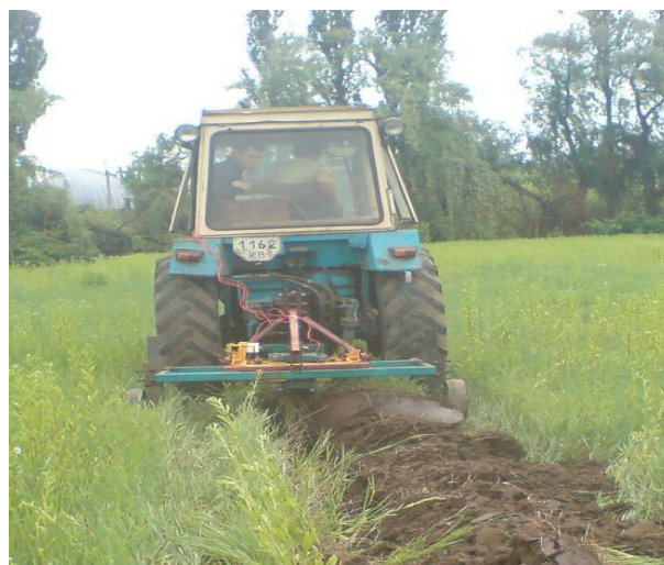
Рисунок 4.1 Експериментальне визначення сил, які діють на корпус дискового знаряддя.
