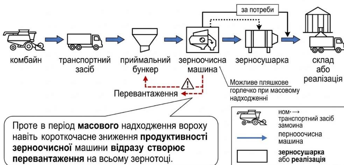
Рисунок 1.2 – Технологічна схема післязбиральної обробки зерна в господарстві
