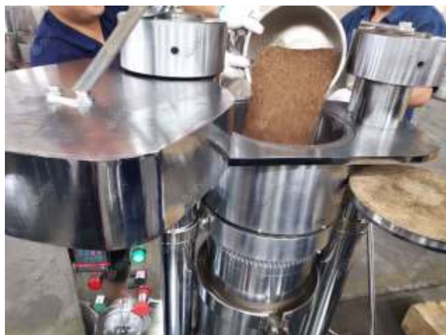
Завантаження насіння кунжуту в гідравлічний прес для олії
