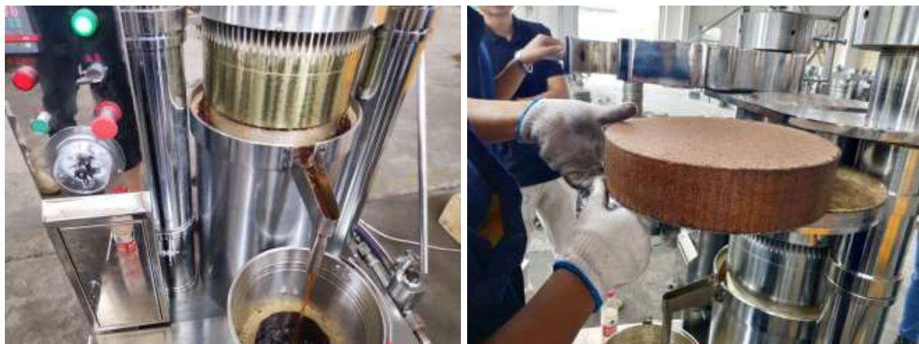
Рисунок 3.2 – Олія і макуха з насіння кунжута, отримана гідравлічним пресом
