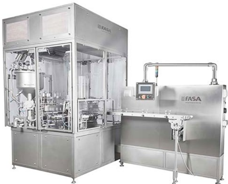
Рис. 21. Машина для пакування рідких продуктів та продуктів пастоподібного типу RFS 120 [23]
