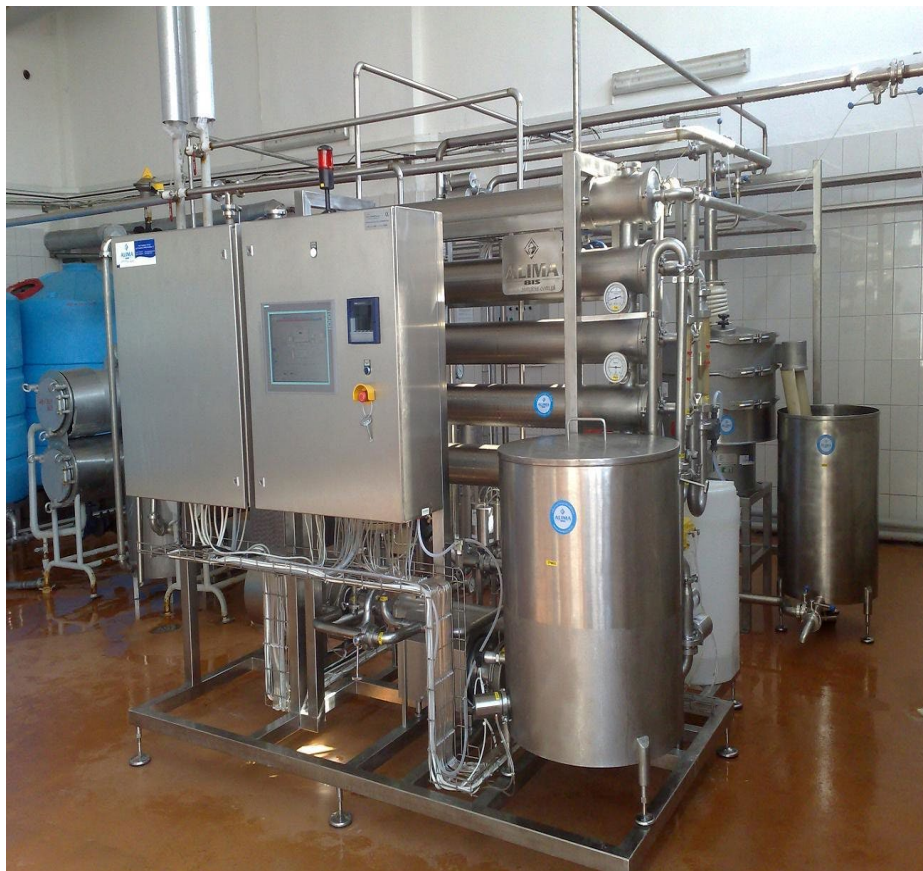
Рис. 17. Установа ультрафільтрації молока компанії Лакта-Сервіс [20]
