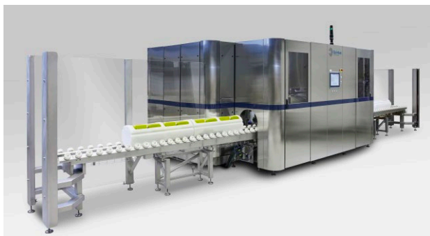
Рис. 8. Установа для обробки молочної продукції під тиском HPP QIF 150L [11]
