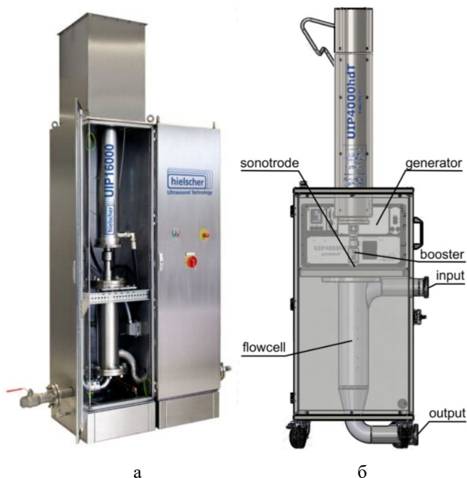
Рис.10. Установки ультразвукової обробки молочної продукції: а) промисловий ультразвуковий гомогенізатор UIP16000 для внутрішньої пастеризації харчових продуктів і напоїв; б) ультразвукова установка UIP4000HDT для нетермічної внутрішньої пастеризації харчових продуктів (наприклад, молочних продуктів, молока, соків, рідких яєць, напоїв) [13]
