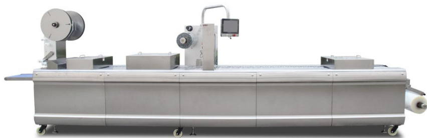
Рис. 59. Термоформуюча вакуумна пакувальна машина Серія DZL-R [60]
