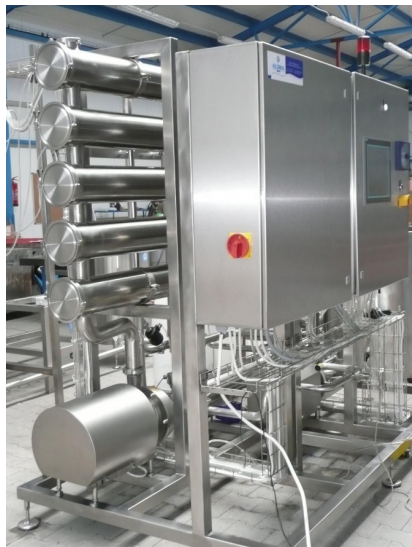
Рис. 16. Установка мікрофільтрації молока компанії Лакта-Сервіс [19]
