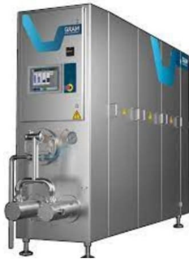
Рис. 22. Промислова безперервна морозильна камера для морозива [24]
