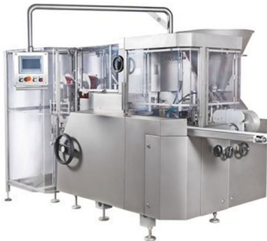
Рис. 51. Машина для наповнення та загортання плавленого сиру [54]
