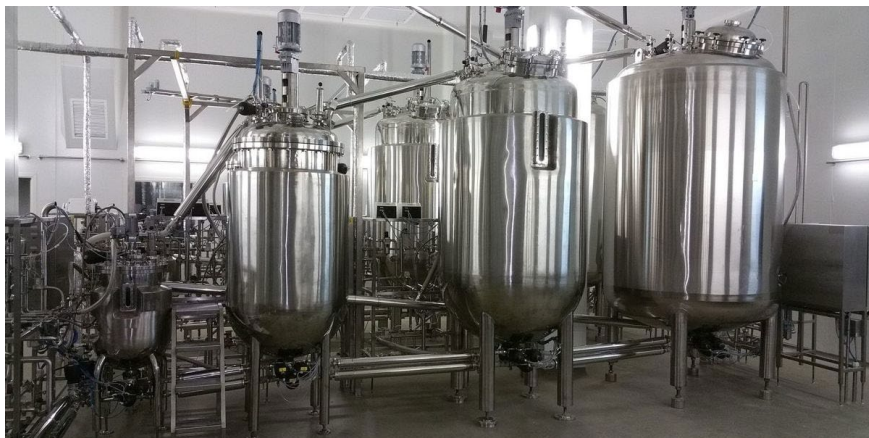
Рис. 31. Установка для криоконцентрування рідких харчових продуктів [33]
