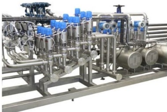
Рис. 60. Система очищення СІР для молочної промисловості [61]
