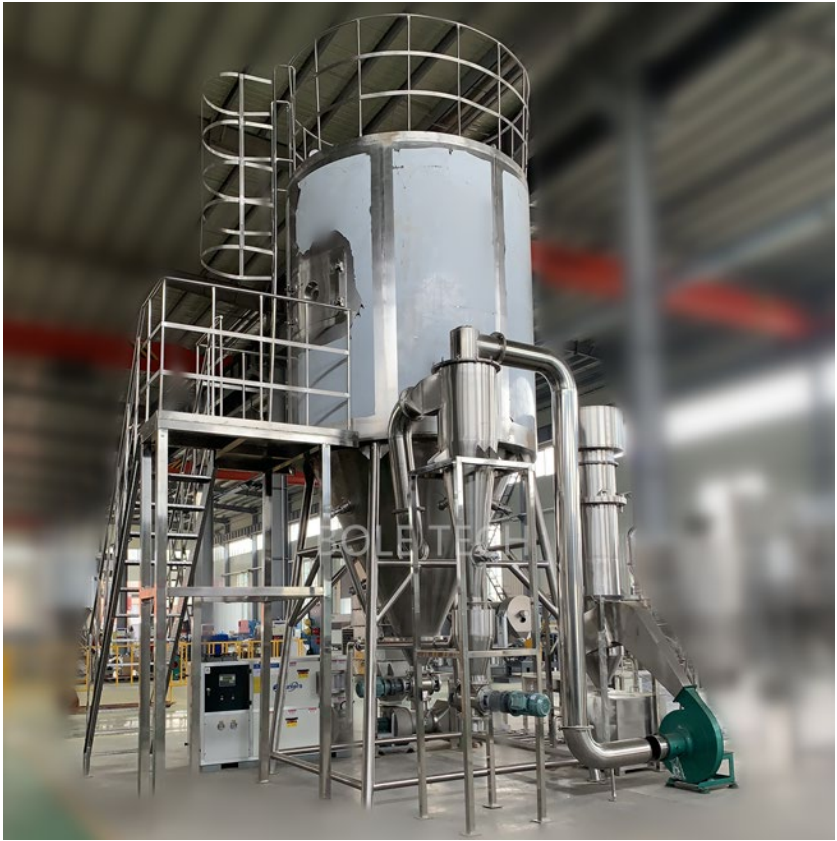
Рис. 27. Установка LPG-500 для сушіння молока розпилюванням [29]
