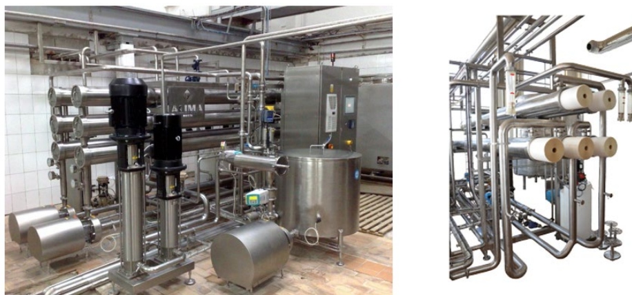
Рис. 18. Установка мембранної нанofільтрації молока компанії Лакта-Сервіс [21]
