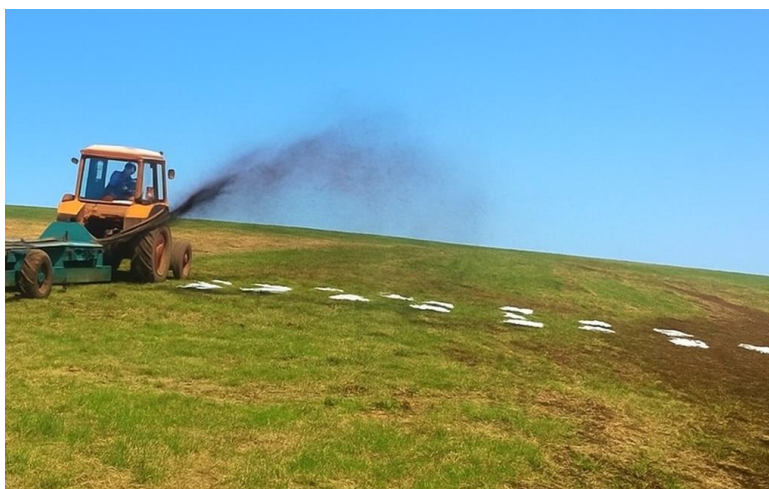
Рисунок 3.10 – Визначення нерівномірності внесення добрив на стаціонарі
