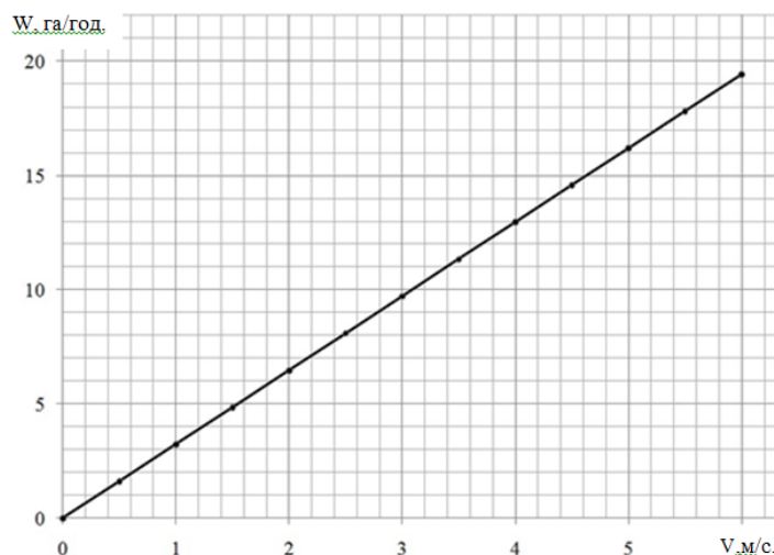
Рисунок 3.31 – Залежність продуктивності від швидкості руху агрегату
