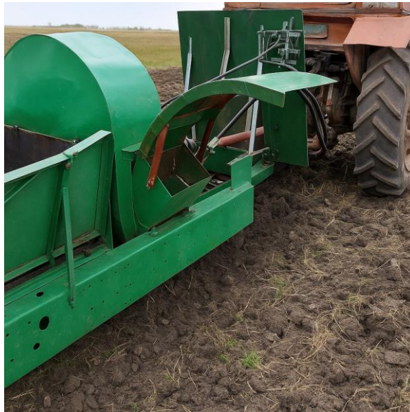
Рисунок 3.11 – Дослідний зразок дефлектора з радіусом 980 мм
