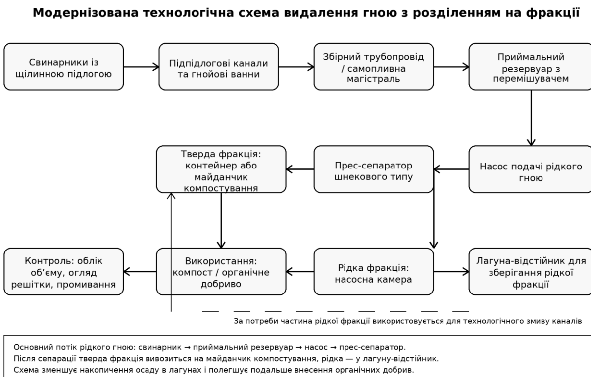
Рисунок 2.1 – Технологічна схема модернізованого процесу видалення гною на свинофермі з використанням преса-сепаратора
