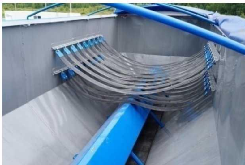
Рисунок 1.9 - Облаштування кузова напівпричепа «Тонар - 95235»
