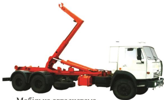
Мобільна автосистема вантажопідйомністю 20 т
