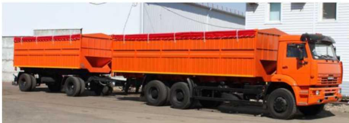
Рисунок 1.6 - Саморозвантажний кузов і причіп Балт «Гранд - Польовик»
