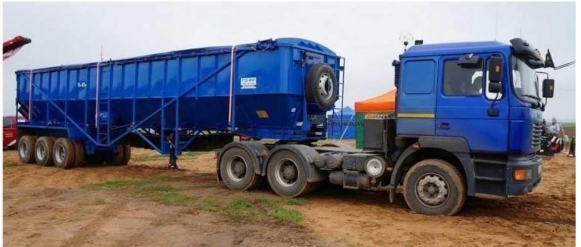
Рисунок 1.8 - Напівпричіп Тонар - 95235 з донним транспортером для розвантаження бульб [16]
