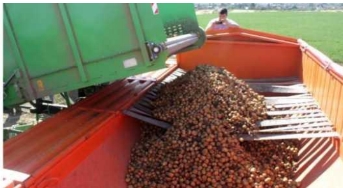
Рисунок 1.5 - Процес завантаження кузова МС з облаштуванням для гасіння енергії падіння бульб
