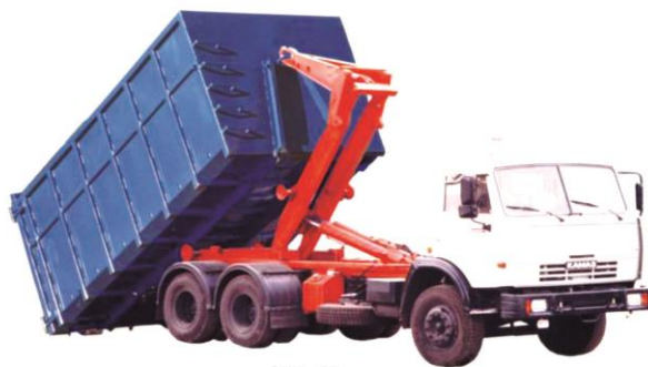
Мобільна автосистема вантажопідйомністю 16 т
