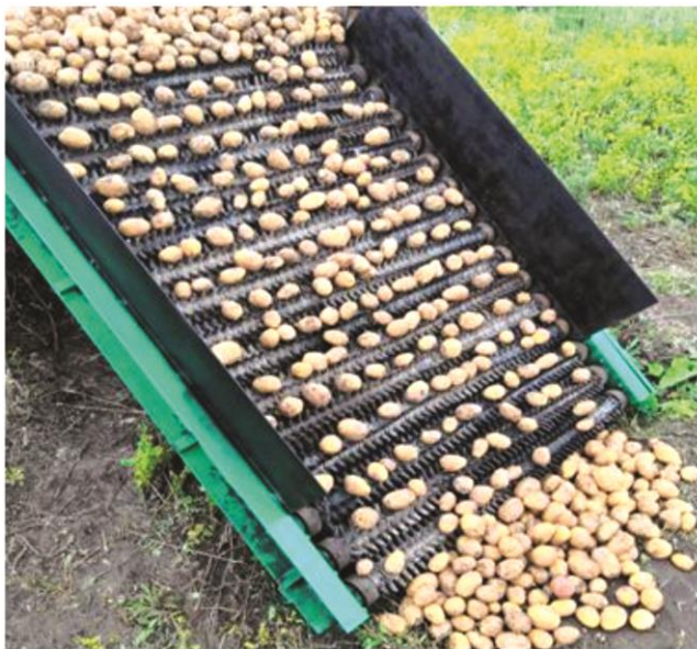
Рисунок 3.2 - Навісний перевантажувальний пристрій в роботі.
