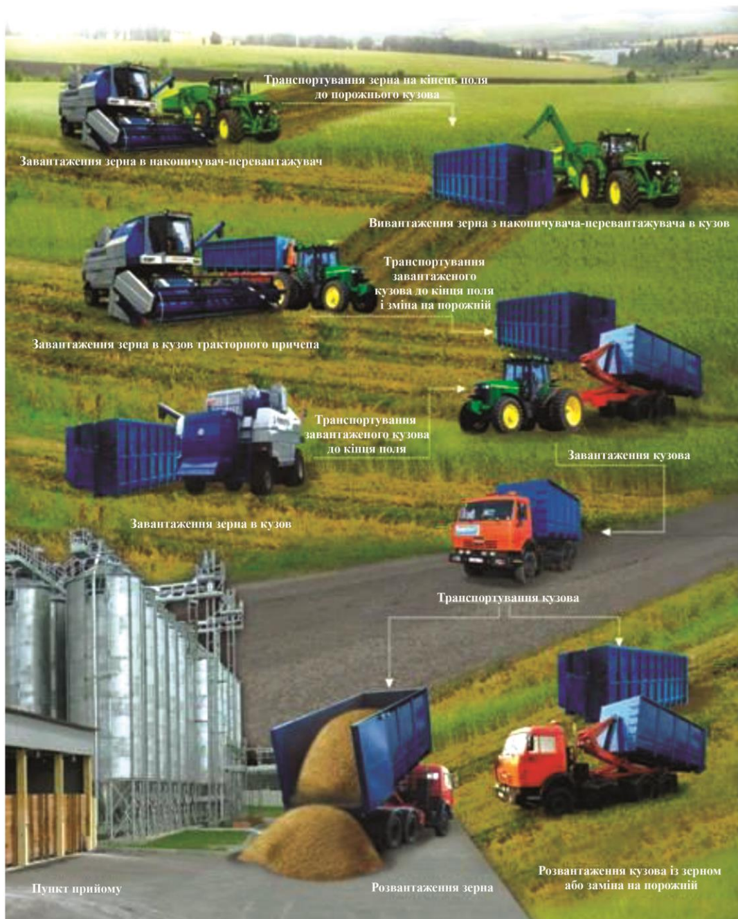
Рисунок 1.13 - Принцип функціонування системи ВІМЛІФТ
