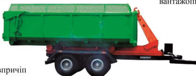
Мобільна автосистема вантажопідйомністю 16 т
