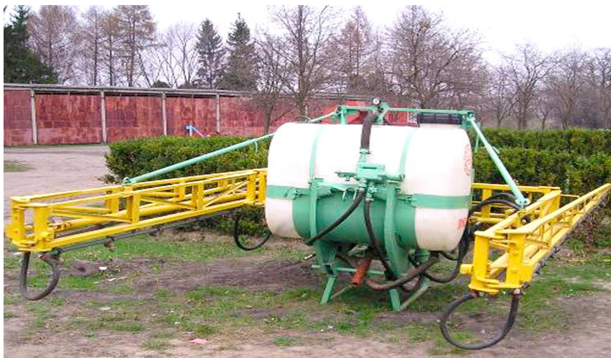
Рисунок 2.2 - Обприскувач мало об'ємний навісний штанговий ОМ-630
