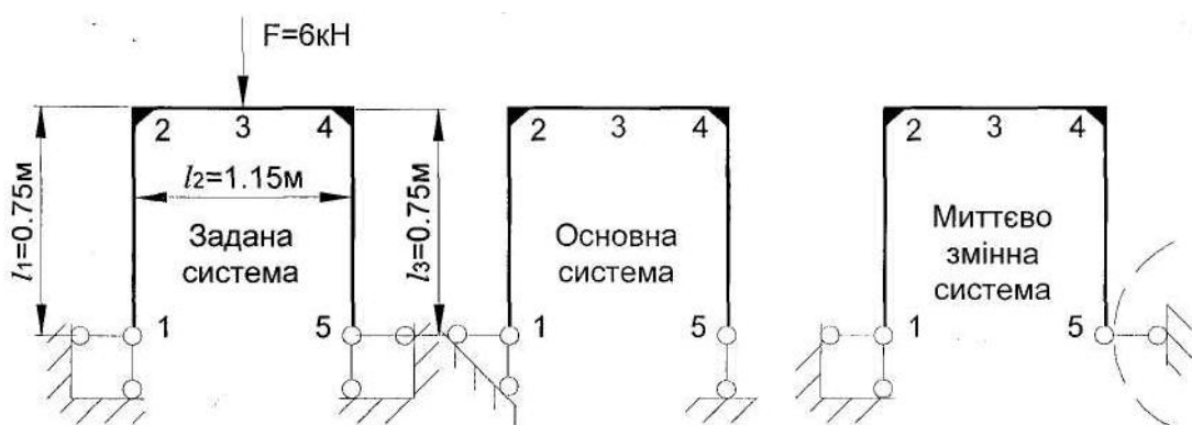
Рисунок .1 - Розрахункова схема рами транспортного пристрою культиватора
