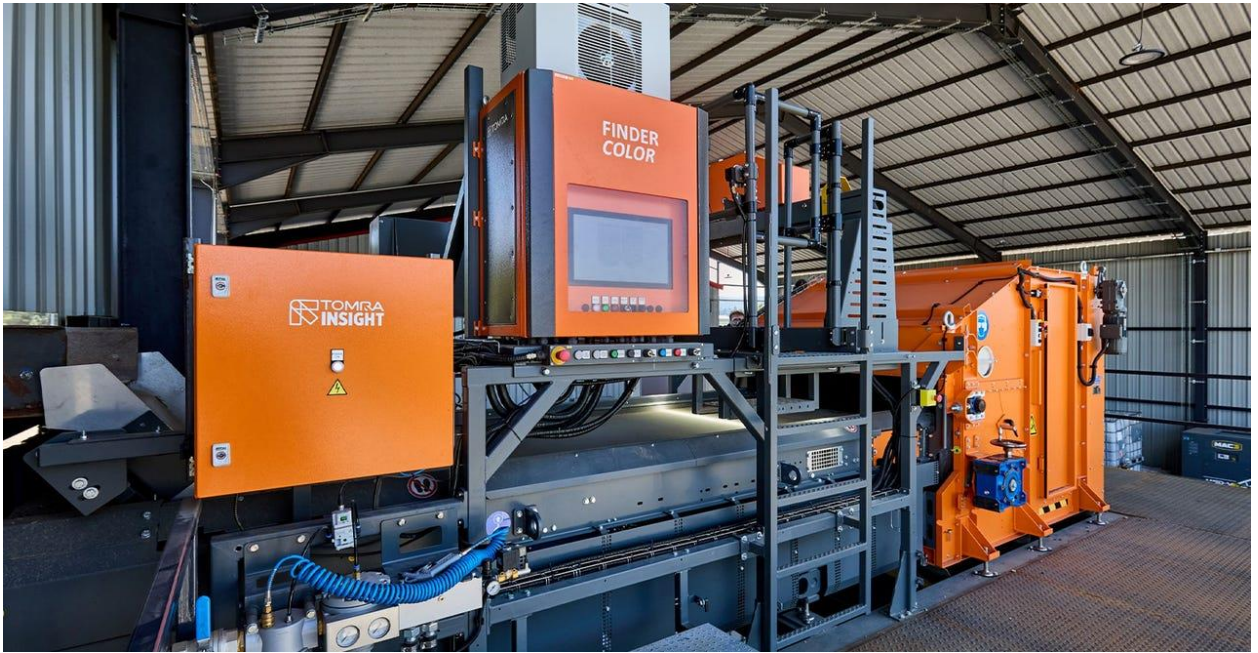
Рисунок 1.1 - Сортиюча установка різних металів «Finder Color» компанії «Tomra»
