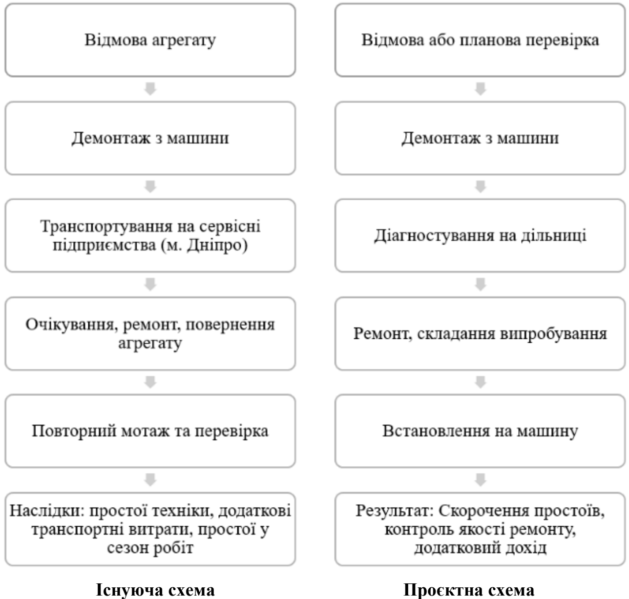
Рисунок 1.2 – Порівняння існуючої та проектної схеми організації ремонту гідроагрегатів
