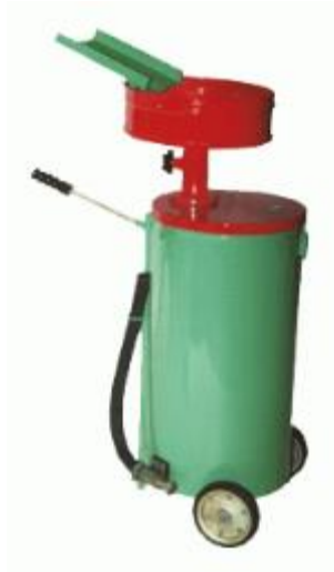
Рисунок 3.1 – Пересувна установка 3508 для збирання відпрацьованої оливи
