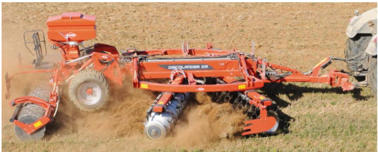
Рис.2.6. Дискова борона DISCOLANDER виробництва KUHN
