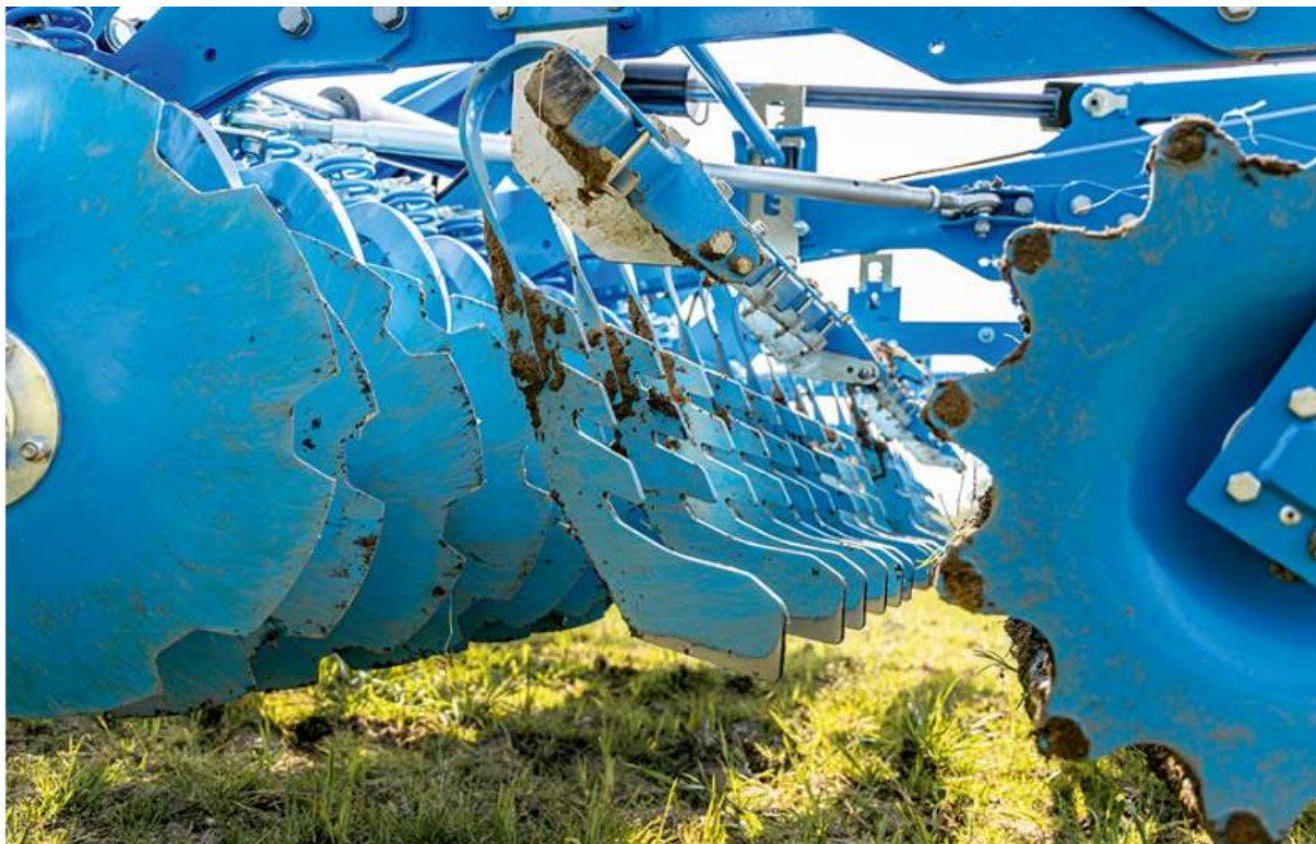
Рис.2.4. Вирівнювальний штригель борони Rubin 10 TF
