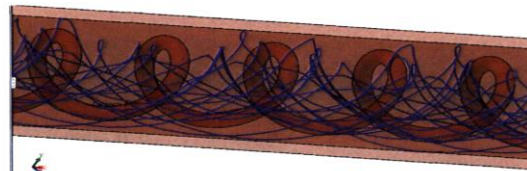
Рисунок 2.9 - Схема формування повітряного потоку біля виходу з гнучкого рукава.
