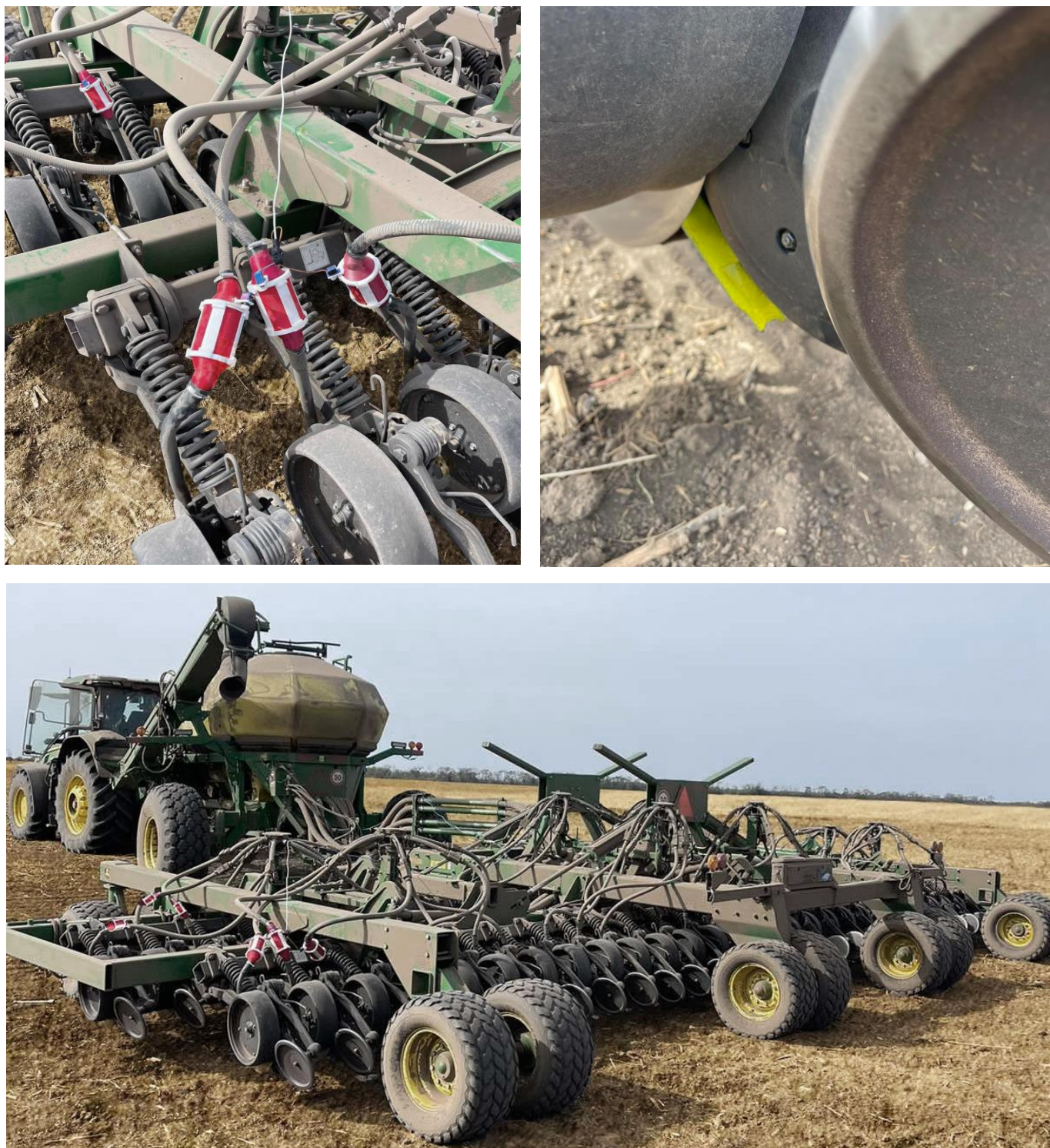
Рисунок 3.11 – Експериментальний зразок секції пневматичної зернової сівалки точного висіву на базі John Deere 90 Series
